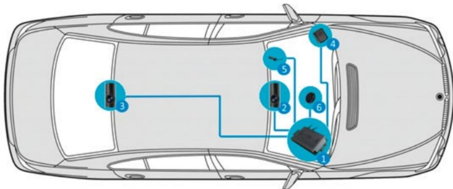
1. Установка основного блока, например, под рулевой колонкой, перчаточным ящиком
