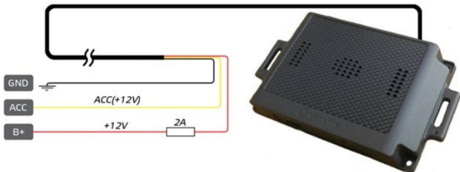
Подключите провод питания согласно схеме. Красный(плюсовой) провод подключите к контакту +12В, где напряжение не пропадает после выключения зажигания.
